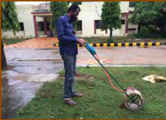
चित्र 2.17. एनआरआरआई विकसित शक्तिचालित निराई उपकरण का प्रदर्शन।
